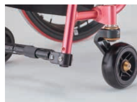
アルミパイプジョイント(ポストパイプ先端カット)
