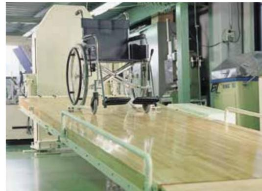
**床面傾斜可動試験機**
