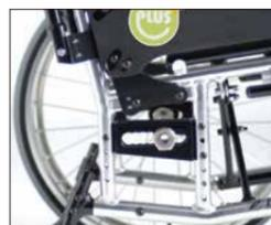
フレームと同一面にセットできる車軸ブラケットにより、車輪を本体に近付け、漕ぎやすさが向上しました。車軸の上下/前後位置設定可能。
