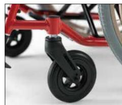
路面からの振動をソフトに吸収するソフトフォーミングキャスト(電動専用タイプ)。
